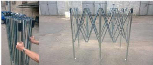
4. Не уходя со своих мест, мужчинам необходимо сменить место ухвата с ножек каркаса на нижние ребра крыши каркаса (см. фото ниже).
