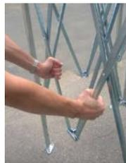
5. Приподнять каркас за нижние ребра крыши и тянуть одновременно в противоположные стороны и вверх настолько, насколько это возможно. Цель - растянуть каркас максимально сильно (где-то на 95%). Растягивание можно проводить в несколько этапов, устанавливая каркас на землю, чтобы было удобнее.
